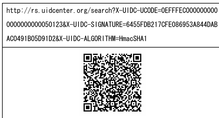
図 4: ゲートウェイアドレス形式によるエンコード例
